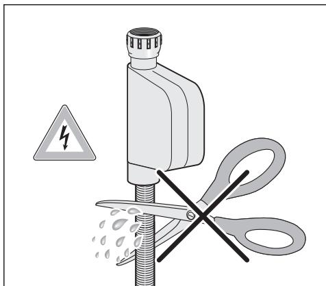
**⚠ Nebezpečí úrazu elektrickým proudem v důsledku síťového napětí.**
