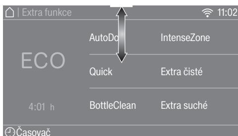
Pro otevření přetáčecího menu stiskněte oranžovou čárku na horním okraji obrazovky a přejedte prstem dolů.
